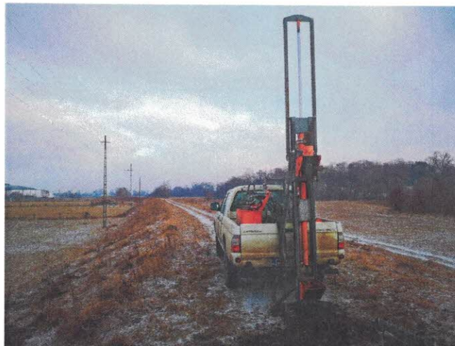
Foto.2: Aspectul terenului de fundare studiat și instalația de foraj geotehnic Pride Mount 20 utilizat.
